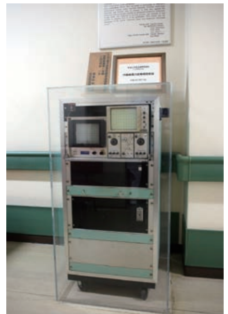
リニア電子走査形超音波診断装置 世界実用第一号機
